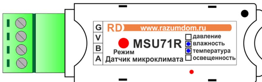
2. Подключить к модулю шину RS485 и подключить её через интерфейс RS485 к ПК. Подключить модуль к источнику питания 24В или 12В или 5В.
